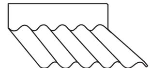
23 Right apron flashing Raccord de mur droite
