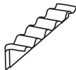
21 Right shed flashing Faîtière shed droite
