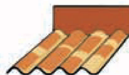
Left apron flashing Raccord de mur gauche
